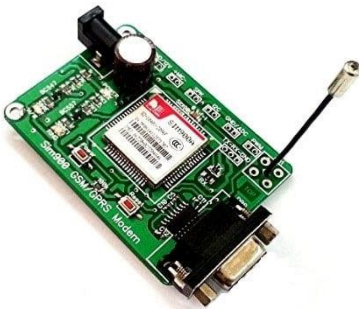
2.6 Сурет - SIM900A GSM / GPRS модулі
